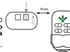
**3) Posizionare il radiocomando originale** ad una distanza di circa 10 cm e **premere e tenere premuto il tasto che si vuole duplicare fino a che il led** del Magiko emette **3 lampeggi VERDI lenti** seguiti da **alcuni lampeggi veloci**.
