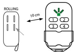
**3) Posizionare il radiocomando originale** ad una distanza di circa 10 cm e **premere il tasto che si vuole duplicare fino a che il led** del Magiko emette alcuni lampeggi **VERDI veloci** seguiti da **6 lampeggi lenti**.
